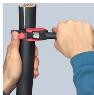
Otáčení nástroje pro obvodový řez
