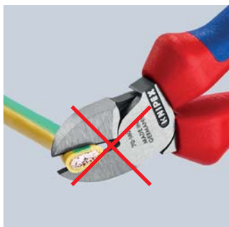
Přestřížení kabelu bočními štípacími kleštěmi: vynaložení velké síly, nečistý řez, silná deformace a mačkání kabelu
