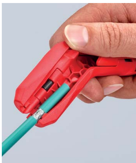
Odizolování datového kabelu
