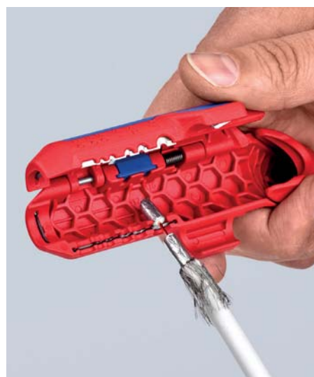
Odizolování koaxiálního kabelu
