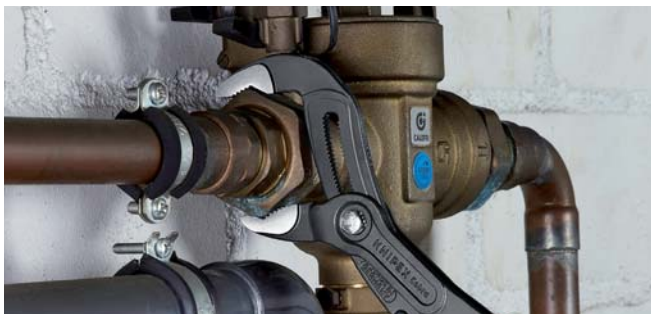
Žuby přesazené proti směru otáčení způsobují samosvorný efekt a zabraňují sklouznutí po obrobku.
