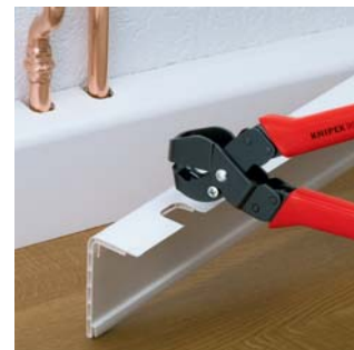
Speciální kleště pro speciální použití, např. pro prostře- žení nebo vyrážení různých materiálů (nůžky na plech, kleště na štípání dlaždic atd.)
