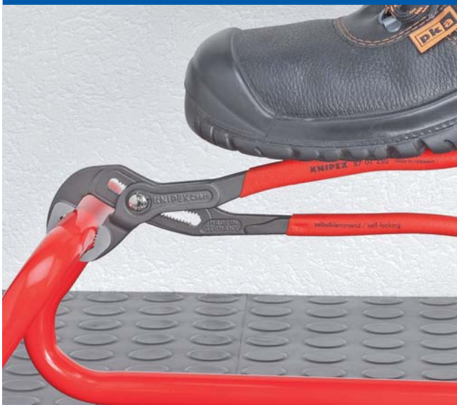
Žuby přesazené proti směru otáčení způsobují samosvorný efekt a zabraňují sklouznutí po obrobku.
