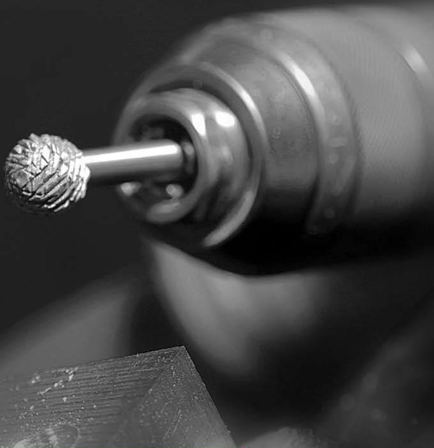
ROTARY FILES AND RASPS / ROTATIONSFEILEN UND ROTATIONSRASPELN / Борфрезы толстые, тонкие и рашпильные
